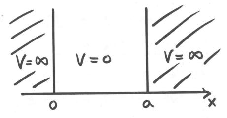
SINCE  $V \neq V(t)$  SOL'N IS OF FORM  $\psi(x,t) = \phi(x) e^{-itE/t}$
